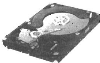
Рис. 2.22. Жесткий диск со снятой крышкой корпуса
